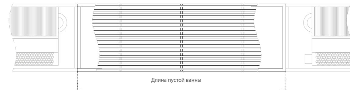
Дополнительная секция ванны не приспособлена для установки теплообменника или вентиляторов. Максимальная длина ванны составляет 4 м. Решетки и рамки также адаптированы к конечной длине.
