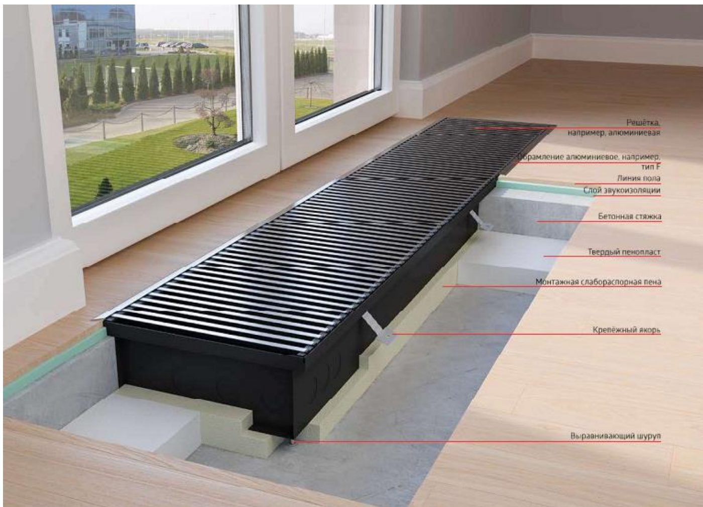
Примерный монтаж неглубокого внутрипольного конвектора
